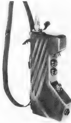
Bild 8. Handfunksprechgerät FuG 6b mit 40 einstellbaren Kanälen. Es arbeitet mit Frequenzmodulation im Bereich um 173 MHz (SEL)
