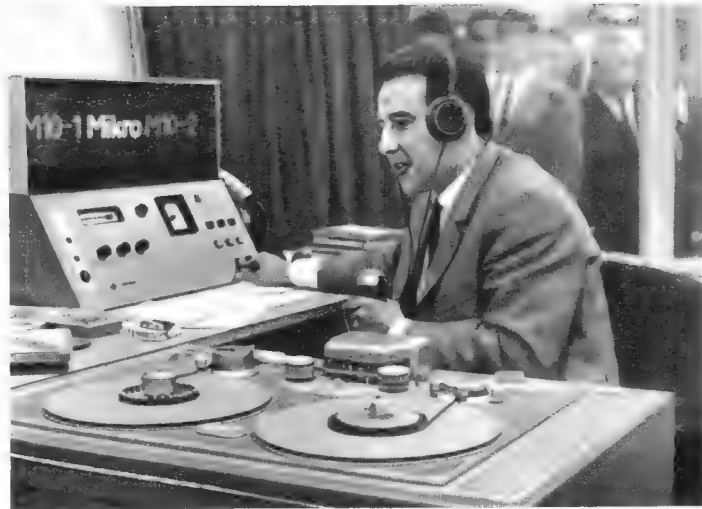
Bild 13. Einmannstudio mit Regietisch und zwei Magnetophonanlagen M 10 (Die Aufnahme entstand während einer Rundfunkreportage; der Diensthabende trägt natürlich keine Kopfhörer und benutzt auch kein Handmikrofon)
