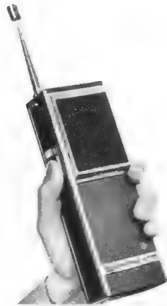
Bild 7. Telecommander – ein neues Handfunksprechgerät für das 27-MHz-Band (Telefunken)
