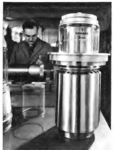
Bild 2. Sendetriode RS 2041 mit einer Anodenverlustleistung von 220 kW. Links neben der Röhre das Maschengitter und ganz links der fertige Katoden/Gitter-Aufbau (Siemens)
